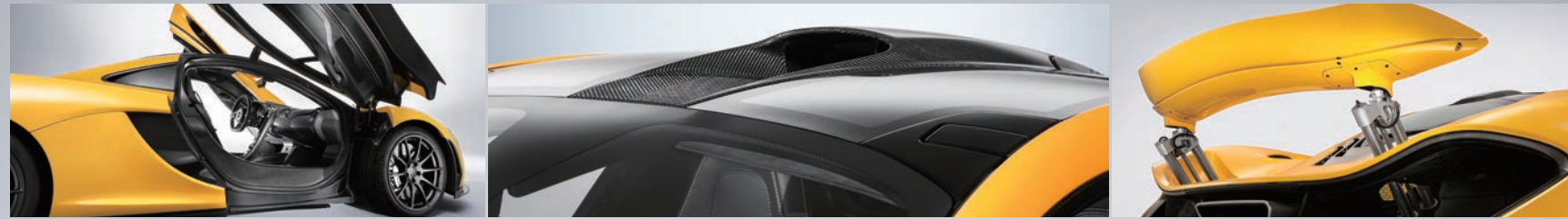
P1은 워든지 대단하다. 탑승 공간을 이루는 카본파이버 소재의 상자형 모노케이지의 무게는 90kg에 불과하고, 꼬리날개가 불꽃 솟아오르면 F1의 DRS와 같은 원리로 공기저항을 23%나 감소시킨다.
