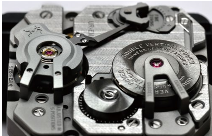
오차 측정 센서와 회로를 장착하지 않은 상태의 EMC 무브먼트.
