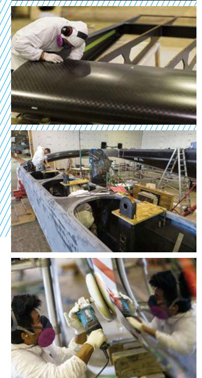
디펜더(지난 대회 챔피언)인 오라클 팀 USA의 AC72 경기정 건조 장면. 탄소섬유 복합재로 만든 윈 세일의 형상은 비행기 날개와 흡사하다(위). 가로대로 결합한 조립한 유선형의 선체 내부 구조를 작업(가운데). 자동차 광택 작업과 비슷해 보이는 과정은 유체 저항을 최소화하기 위한 작업이다(아래). ©GUILAIN GRENIER/ORACLE TEAM USA
